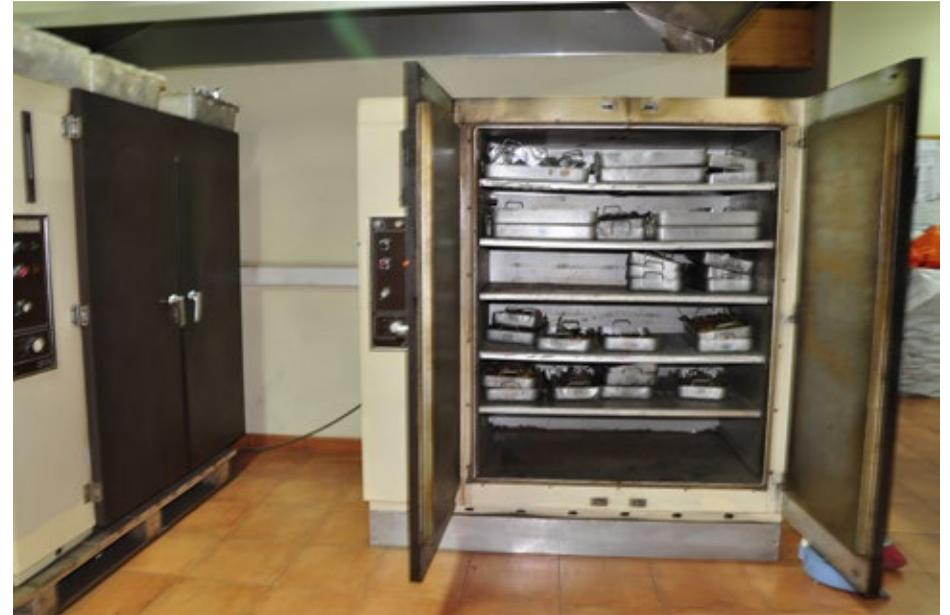
Figura 15. Muestras de combustibles dispuestas en cámaras de secado con aire forzado
